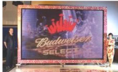
今回の3Dディスプレイの3D映像の実現方式は、同社の液晶版3Dディスプレイと同様、視差(パララックス)バリア方式である。視差バリアのスリットを斜めに配置する点も含めてほぼ同じ技術で、3D映像コンテンツも液晶版向けのものがそのまま使えるとする。
